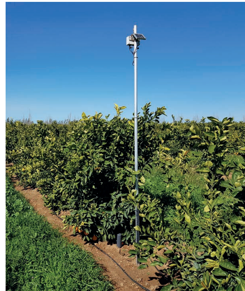
Sonden messen an den Wurzeln die Feuchtigkeit des Bodens.
